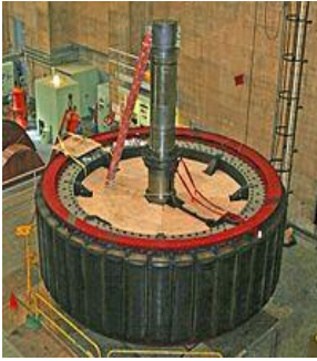
Figura 1-10 Electroimán y anillos colectores.
