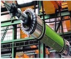
Figura 1-10 Electroimán y anillos colectores.
