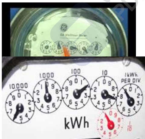
Figura 6-8 Medidor de y escala.
