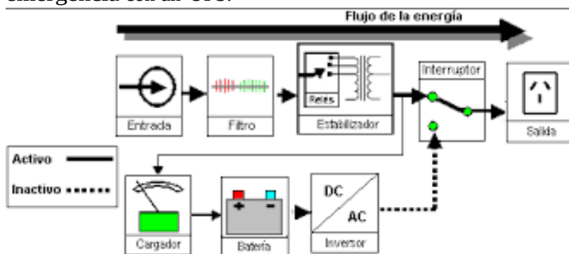
Figura 6-23 Sistema UPS.
