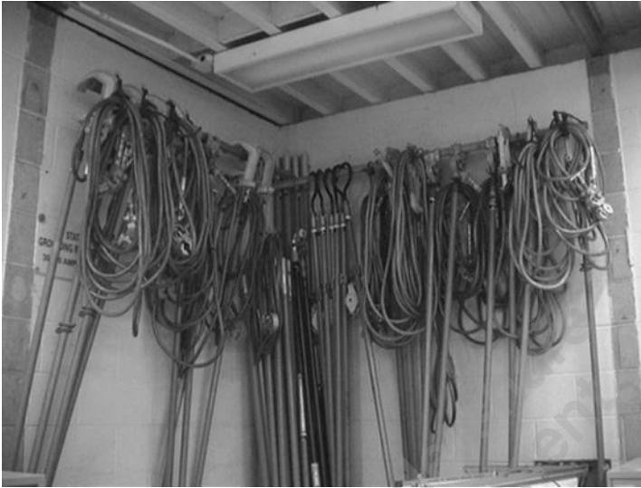
Figura 10-10 Puentes de puesta a tierra.
